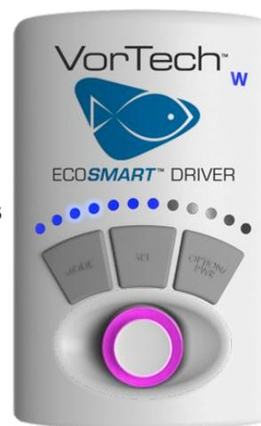
L'illustration ci-dessus montre le contrôleur EcoSmart en mode EcoSmart (Molette mauve). La 3ème et 4ème LED illuminées fortement montrent que le contrôleur est configuré en mode “NTM”. Les LEDs éclairées plus faiblement montrent la vitesse réglée.
