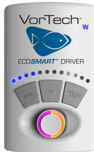
Le contrôleur est ici en mode nuit et en configuration de durée. La durée est réglée sur 6 heures (réglage par défaut 10 heures).
