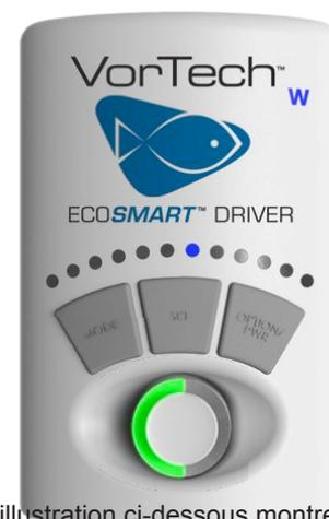
L'illustration ci-dessous montre la contrôleur en mode "batterie de sauvegarde"
