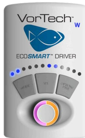
Le contrôleur est ici en "mode alimentation" et en configuration "réglage de la vitesse". Le réglage est "mouvement faible" (le rég. par défaut est 50% plus faible que la vitesse min.)
