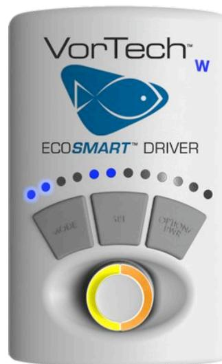
Le contrôleur est ici en mode "alimentation" et en configuration de la durée. Le réglage est de 5 minutes (réglage par défaut 10 minutes).
