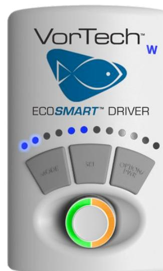
Le contrôleur est ici en “mode nuit” et en configuration “réglage de la vitesse”. La vitesse est réglée au min. (le réglage par défaut et de 50%).
