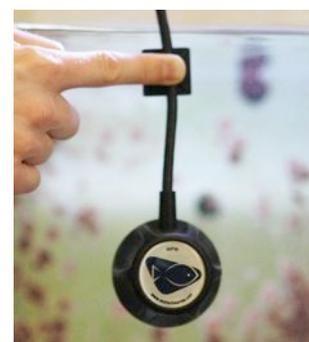
Note: Protégez la pompe contre les chutes. En raison de la nature de la conception de l'accouplement magnétique, il est éventuellement possible que la pompe VorTech se détache de l'aquarium et tombe sur le sol. Le câble doit être placé verticalement au-dessus de la pompe et maintenu grâce à l'attache fournie afin d'éviter que le moteur ne se déplace dans le cas d'un découplage. Cette attache DOIT être utilisée pour prévenir tout dégât au moteur et à son environnement.
